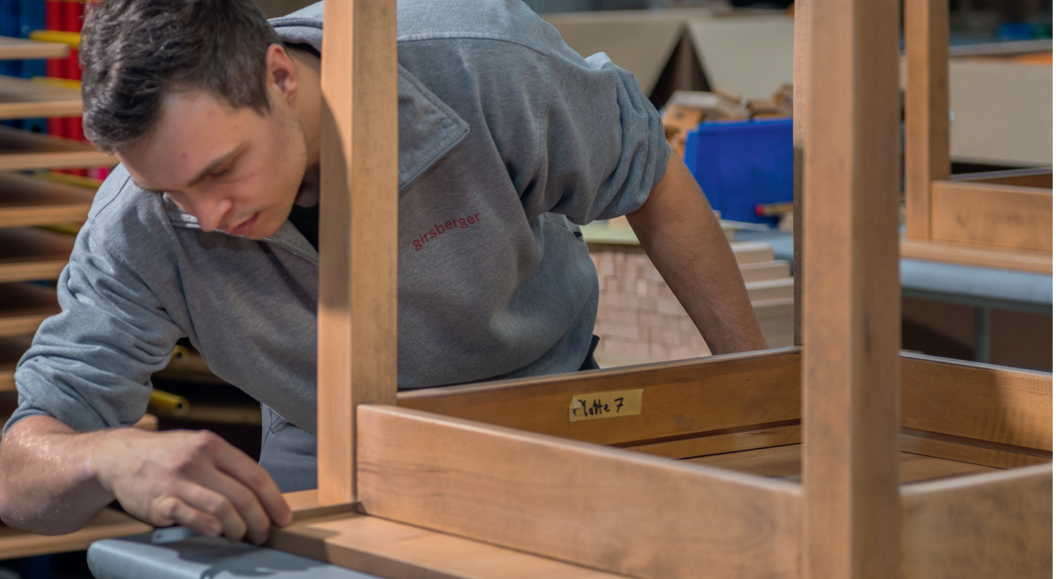
Flicken statt wegwerfen: Beim Möbelhersteller Girsberger werden alte Tische neu verschraubt, geschliffen und lackiert.
